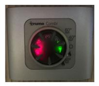
Das kann passieren, wenn Sie vergessen haben die Gaszufuhr am <u>Gasabsperrventil</u> zu aktivieren. Schalten Sie dann die Truma Combi 6 aus, kontrollieren die Gaszufuhr und schalten dann die Truma Combi 6 wieder ein.
